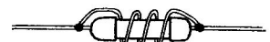
9 PS (パラ止) 50Ω 1/2W P型抵抗に 1mm メッキ線を 3~5 回巻く
