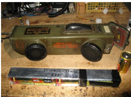
自作DC-DCコンバータ (単1電池3個 4, 5Vで105V出力)
