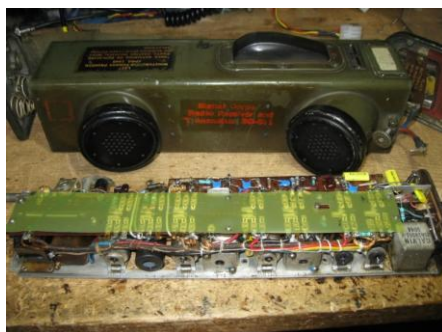
電池管5球の内部
