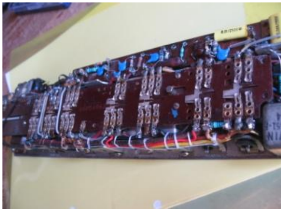
左7195KHz用送受水晶と自作したANTコイルとタンクコイル
